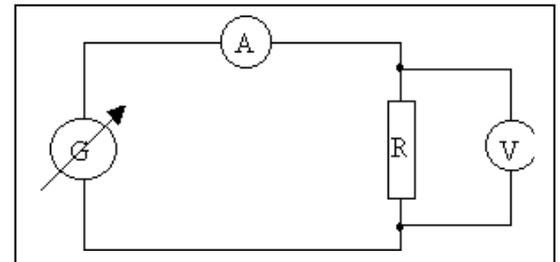
En faisant varier la tension du générateur, on obtient une série de mesures qu'il est préférable de représenter dans un tableau
